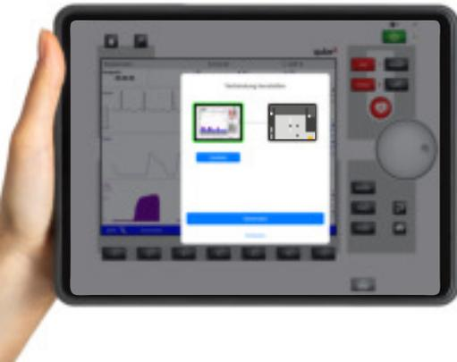
Sie werden auf dem Monitor aufgefordert, den Controller mit dem Monitor zu verbinden. Sind die Geräte miteinander verbunden, wird dies durch einen Haken bestätigt.
